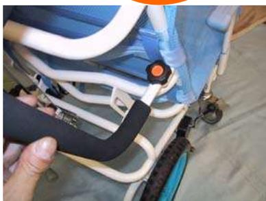
③ 介助グリップを左右に小さく振りながら、ノブを矢印の方向に締めていき、グリップの止まる位置でしっかり締めます。
